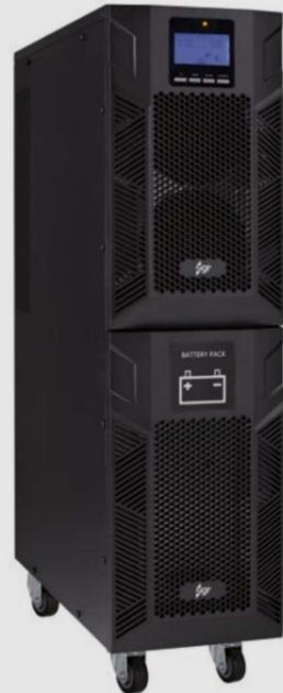
En este rango de potencias disponible de 6 y 10 kVA, se incorpora la tecnología de paralelado de hasta 4 unidades, que permite un crecimiento escalonado de su instalación sin necesidad de invertir en un nuevo SAI/UPS.
