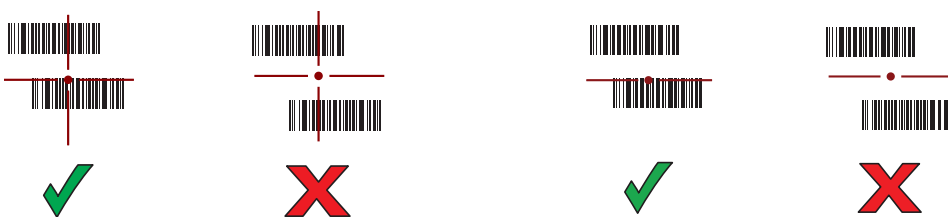
Figura 39 Modo de lista de selección con varios códigos de barras en un patrón de enfoque: rango estándar y ampliado
