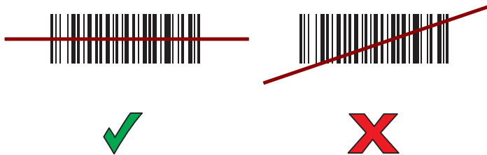
Figura 40 Patrón de enfoque del lector láser
