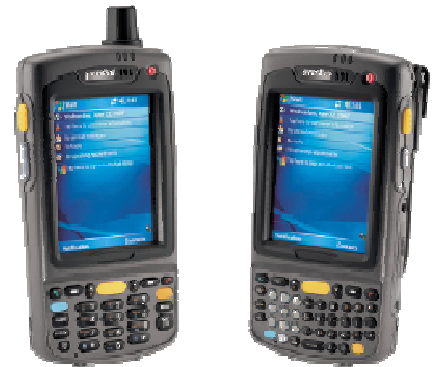
SYMBOL MC70: QVGA de 3,5 pulgadas de color transreflectivo con Retroiluminación. Triple modo IEEE® 802.11a/b/g Bluetooth: Clase II, v 1.2 Telefonía integrada
